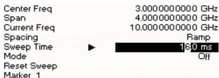
Bild 4-23 Ausschnitt Menü Sweep - Freq - Beispiel Spacing Ramp (Rampen-Sweep, SMR-B4)
